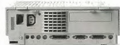
Voor de aansluiting van apparatuur: twee seriële poorten, een beeldscherm, SCSI, externe schijf-eenheid, een Apple Desktop Bus, geluidsuitvoer en een geluidsinvoerpoort alsmede een interne uitbreidingsleuf.
