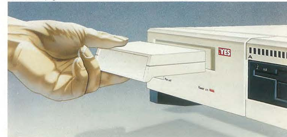
ROM stekker voor programma's, waardoor de :YES ook zonder diskette bruikbaar is.
